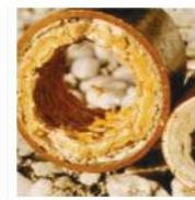
Os minerais presentes na água, sobretudo o calcário e o magnésio, acumulam-se continuamente nas paredes dos circuitos. O resultado é a perda contínua do fluxo até a obstrução completa.
